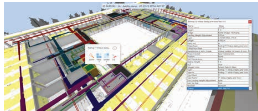
3 pav. Administracinio pastato Laisvės pr. 36, Vilniuje, BIM modelis sugretinamas su brėžiniais, peržiūrima elementams priskirta atributinė informacija
